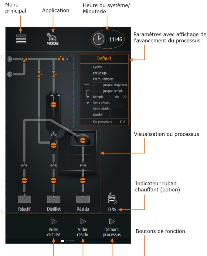
La fenêtre de démarrage permet d'accéder au menu principal, à la sélection directe d'un mode de fonctionnement et à la sélection de l'affichage de l'heure.
