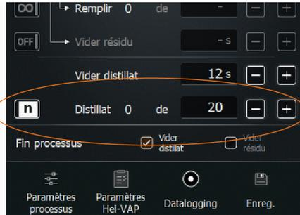
Dans l'exemple : six vidages de distillat, ensuite la durée d'évaporation supplémentaire activée en option s'écoule. Cela permet d'atteindre une concentration souhaitée !
