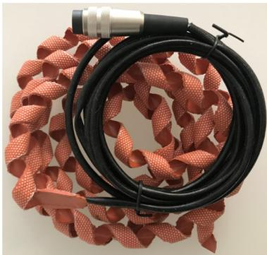
Le ruban chauffant est connecté au Distimatic Pro et intégré au logiciel du système à l'aide de la carte d'extension Heat Control correspondante.
