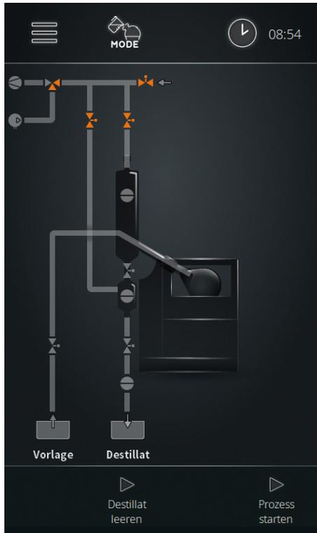
Im manuellen Modus können Einzelproben verdampft werden (Batch-Betrieb). Zum automatischen Befüllen des Verdampfungskolbens und zur Entleerung des Destillats stehen die Tasten **Destillat leeren** und **Prozess starten** am Bedienpanel zur Verfügung.
