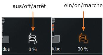
les paramètres de processus du mode de fonctionnement sélectionné définissent le comportement du ruban chauffant (activation automatique, durée de fonctionnement/durée de pause en pourcentage).
