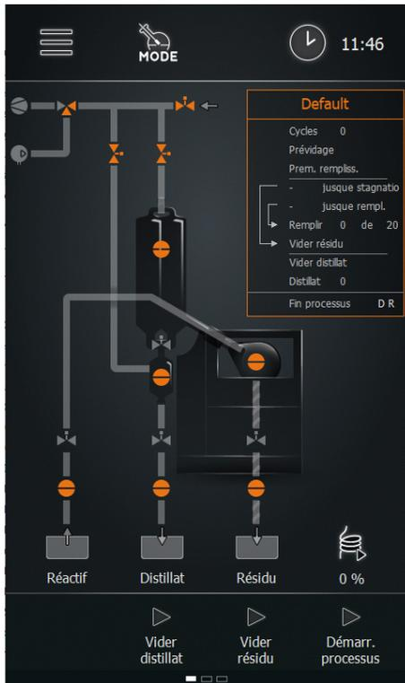
En mode Capteur, la quantité de remplissage dans le ballon d'évaporation est régulée à l'aide du capteur de niveau de remplissage S4. Les statuts du capteur suivants sont possibles :
