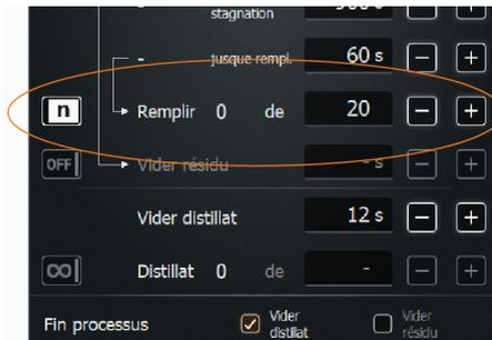
Dans l'exemple : cinq remplissages, ensuite la durée d'évaporation supplémentaire activée en option s'écoule. Cela permet d'atteindre une concentration souhaitée !
