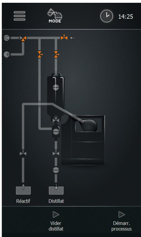
en mode Manuel, il est possible d'évaporer des échantillons individuels (mode Batch). Pour le remplissage automatique du ballon d'évaporation et pour le vidage du distillat, l'appareil est pourvu des boutons **Vider le distillat** et **Démarrer le processus** sur le panneau de commande.
