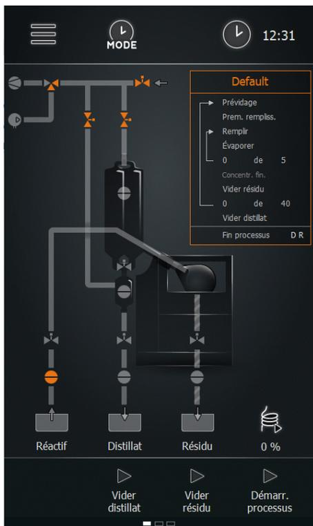
en mode Temps, le remplissage du ballon d'évaporation, la distillation et le vidage du distillat et du résidu sont purement commandés par temporisation :
