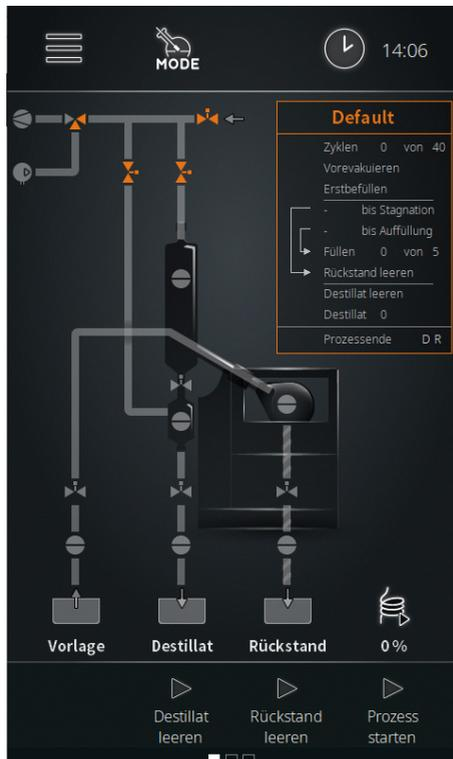
Im Sensormodus wird die Füllmenge im Verdampfungskolben über den Füllstandssensor S4 reguliert. Folgende Sensorstatus sind möglich:
