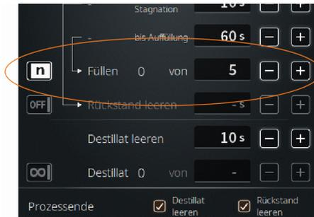
Im Beispiel: fünfmal Befüllen, anschließend läuft optional zusätzlich Verdampfungszeit ab. Hierdurch kann eine gewünschte Konzentration erreicht werden!
