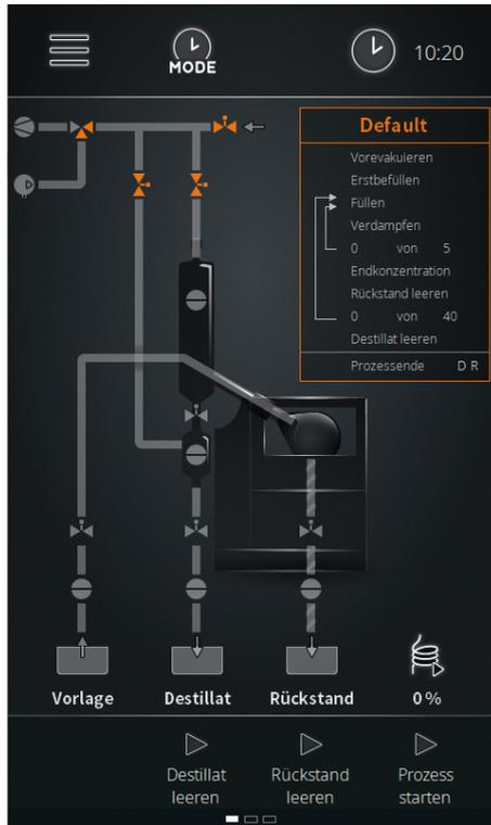
Im Zeitmodus erfolgen die Befüllung des Verdampfungskolbens, die Destillation und die Entleerung von Destillat und Rückstand rein zeitgesteuert:
