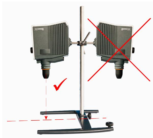
Après le montage de l'agitateur à tige vérifiez le serrage de tous les raccords à vis / toutes les vis de serrage.
