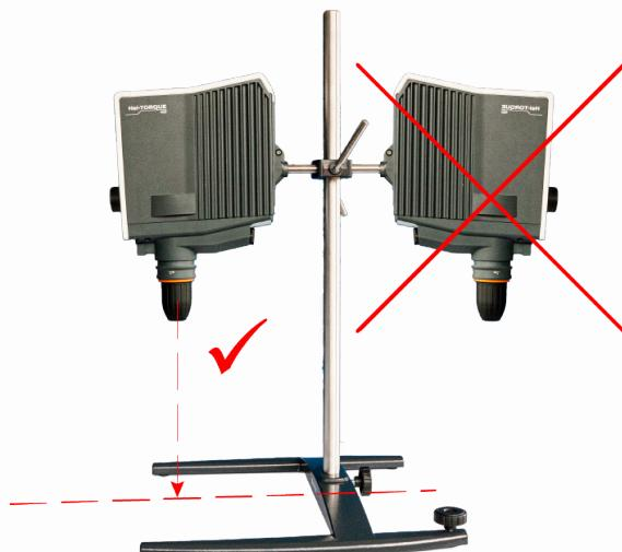
Prüfen Sie nach der Montage des Laborrührers alle Schraubverbindungen / Klemmschrauben auf festen Sitz.
