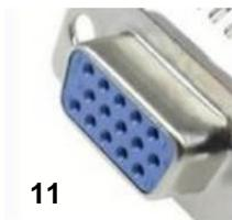
Per collegare l'interfaccia, utilizzare un cavo idoneo con connettori SUB-HDD a 15 poli e collegarlo alla presa (11) sulla parte posteriore dello strumento.
