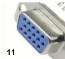
Pour connecter l'interface, veuillez utiliser un câble d'interface avec fiche SUB-D 9 et raccordez-le à la fiche femelle (11) au dos de l'appareil. L'affectation des broches est indiquée dans les schémas «Interface analogique» et «Interface série RS 232».
