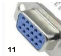
Para enchufar las interfaces de serie utilice un cable con conector SUB-D 9 y conéctelo a la ranura (11) de la parte trasera del equipo. La conexión puede extraerse de los dibujos "Interfaces de serie analógicas" y "Interfaz de serie RS 232".
