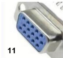
Zum Anschluß der Schnittstelle verwenden Sie bitte ein Schnittstellenkabel mit SUB-HDD 15 Stecker und schließen dieses an die Buchse (11) an der Geräterückseite an.
