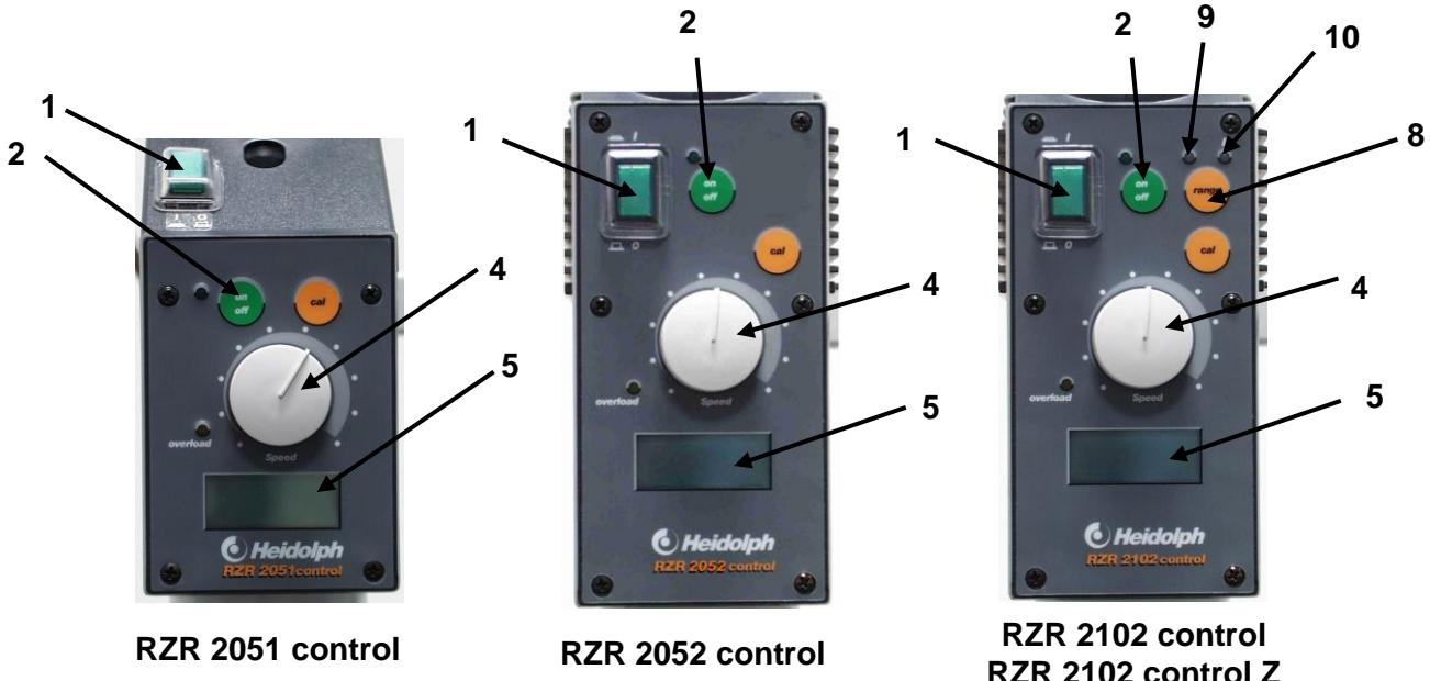
Positionnez le bouton tournant (4) pour le réglage de la vitesse de rotation sur butée gauche. Dès que vous mettez en service l'appareil avec l'interrupteur d'alimentation (1), les indications suivantes apparaissent sur l'affichage (5) :
